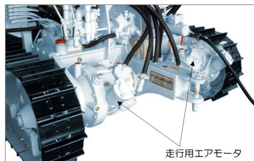
3. トラックガードによって、岩石の噛み込みによるリンクシューの脱輪やトラックローラなどの磨耗を防いでいます。
