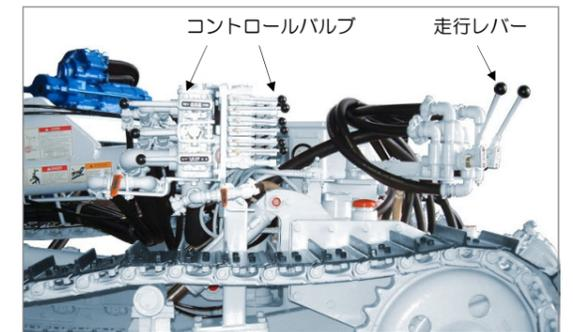
2. フィードモータとドリフタのモータ操作のコントロールバルブをガイドシエルに取付けてあるので、とくにワンマンでの穿孔作業が効率的に行えます。
