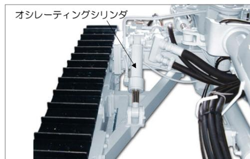
2. テークアップはグリースポンプで簡単にトラックリンクの張りを調整できる油圧方式です。
