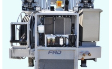
後部点検箇所(カバーOPEN)
