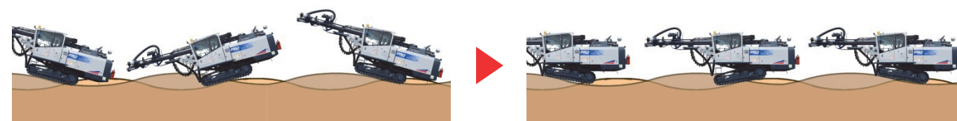
オシレーティング機能無し：路面の凹凸により不安定な走行に。
