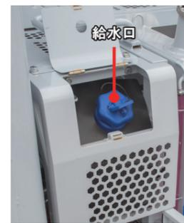
尿素水タンクの給水口をキャビン後部に配置。ステップ上より給水ができます。
