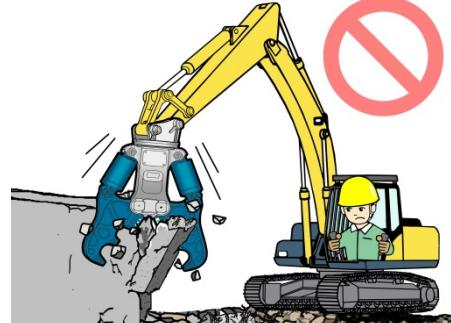
カッター刃でコンクリートの破碎作業をしないでください。カッター刃が摩耗し、鉄筋が切れなくなります。
