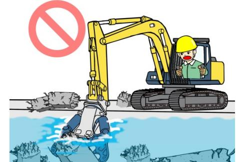
水中での作業は、圧碎機および油圧ショベルの重大な故障につながります。
