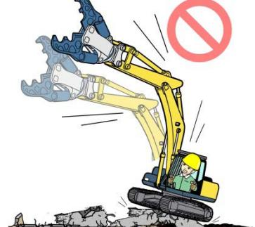
不安定な場所での作業は危険です。作業現場や走路は平坦に整地してください。建物内での作業は床の強度を点検し、十分安全であることを確認し、床の崩落に注意が必要です。
