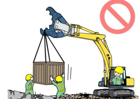
圧碎機によるクレーン作業は禁止です。圧碎機のフックは、圧碎機本体の運搬・積込み用ですので使用禁止です。
