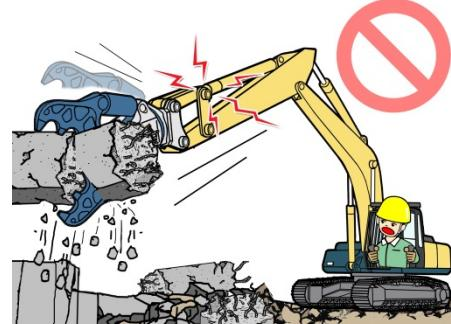
油圧シリンダがストロークエンドの状態では思わず外部の力でロッドの曲りやロッドの抜け、リンクの曲りなどの破損事故につながります。
