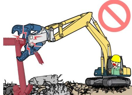
焼入れボルト、ステンレス、ワイヤー、高張力鋼板など、熱処理した材料は切断しないでください。
