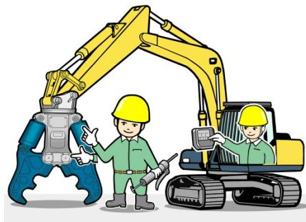
作業の開始前および終了後には、必ず各部点検を行う。（油漏れ、ボルトのゆるみ、油圧ホースの傷、各部へのグリスアップなど）作業中は2~3時間ごとにグリスアップしてください。
