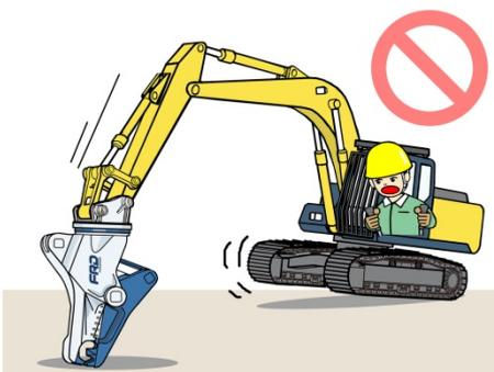
圧砕機を押付けてジャッキアップしての方向転換は、無理な力が発生し双方の故障や事故を引き起こすことがあります。
