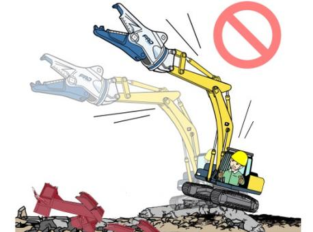
不安定な場所での作業は危険です。作業現場や走路は平坦に整地してください。建物内での作業は床の強度を点検し、十分安全であることを確認し、床の崩落に注意が必要です。
