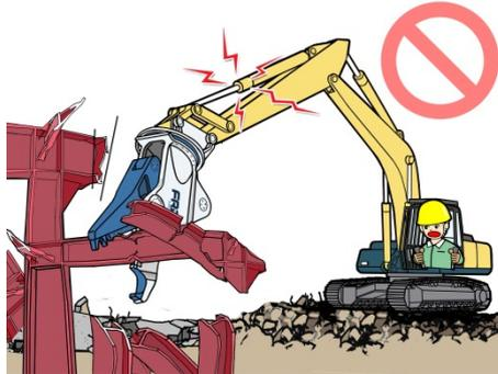
油圧シリンダがストロークエンドの状態では思わぬ外部の力でロッドの曲りやロッドの抜け、リンクの曲りなどの破損事故につながります。
