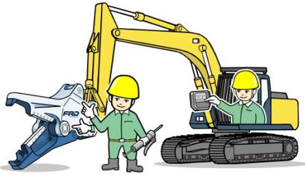
作業の開始前および終了後には、必ず各部点検を行う。(油漏れ、ボルトのゆるみ、油圧ホースの傷、各部へのグリスアップ)
