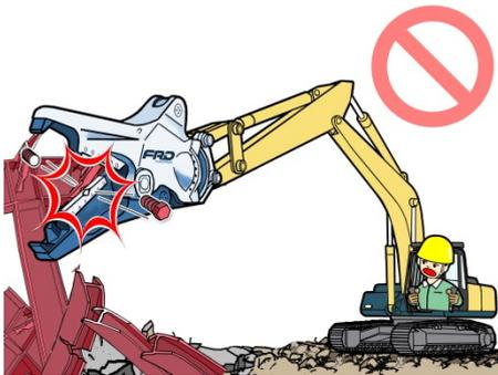
焼入れされたボルトの切断は、カッター刃の欠損につながります。鉄骨接合部の切断作業はしないでください。
