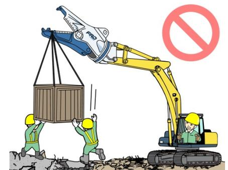
圧砕機によるクレーン作業は禁止です。圧砕機のフックは、圧砕機本体の運搬・積込み用ですので使用禁止です。
