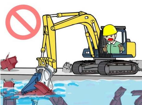
水中での作業は、圧砕機および油圧ショベルの重大な故障につながります。
