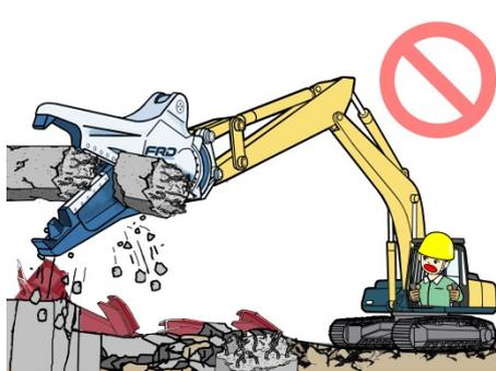
カッター刃でコンクリートの破砕作業をしないでください。カッター刃が摩耗し切れなくなります。
