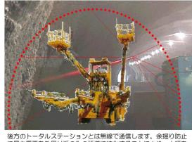
後方のトータルステーションとは無線で通信します。 余掘り防止に最も重要な外周付近のみの誘導に特化することにより、大幅なコストダウンを実現しました。無支保工区間における切羽の伸び縮みも全自動計測するため、誤差のない誘導が可能です。
