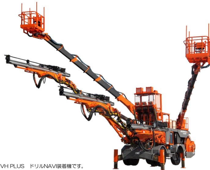
写真はJTH3200R-VH PLUS ドリルNAVI装着機です。
