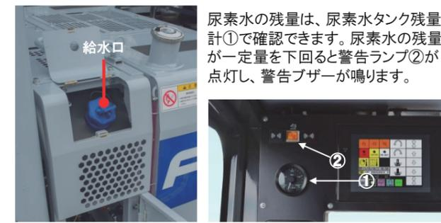
尿素水の残量は、尿素水タンク残量計①で確認できます。尿素水の残量が一定量を下回ると警告ランプ②が点灯し、警告ブザーが鳴ります。
