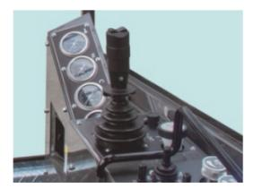
せん孔レバーには、フィット感のよい大型グリップ式を採用。打撃・フィード・回転の各動作を制御します。
