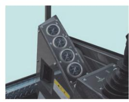
作業中の視線移動をできるだけ小さくするよう、各圧カゲージをサイドピラー側に配置しました。
