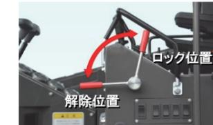
走行やロッドチェンジャが作動しないよう機能を停止させます。誤操作を防止するため、油圧カットレバーを引き上げロックしてください。
