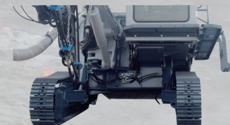
両サイドのエンジンカバーは、ガスプリングのサポートでラクに開くガルウィング式です。油圧機器や各種フィルタ類などの点検箇所を集約し、点検・整備がよりラクに行えます。電気トラブルを未然に防止する耐候・耐水・耐油性のあるケーブルや防水カバーを使用することで、メンテナンスコストも低減します。
