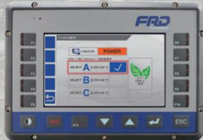
岩質に応じて適正なエンジン回転速度を選択することで、打撃性能を維持しながら燃費改善に貢献する最先端の低燃費化技術です。
