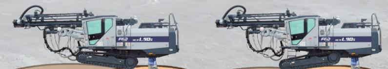
オシレーティング機能有り：左右の履帯が接地し安定した走行が可能
